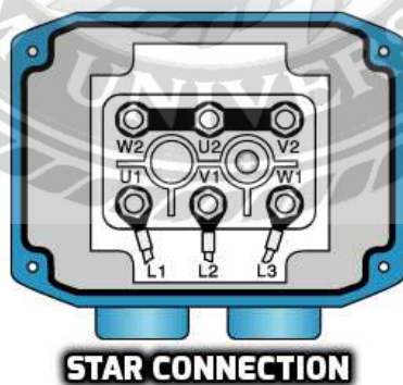
รูปที่ 2.3 การต่อวงจรมอเตอร์แบบสตาร์ ( Star Connection )
