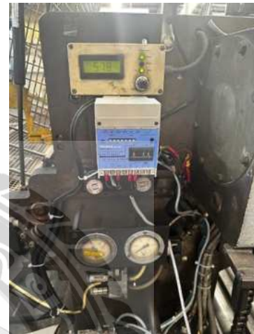
รูปที่ 4.4 การติดตั้งเซนเซอร์ของจำนวนแผ่นเหล็กที่เครื่องเคลือบสี
