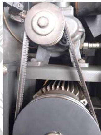
รูปที่ 4.13 สายพานส่งกำลังที่เสื่อมสภาพมีรอยแตก
