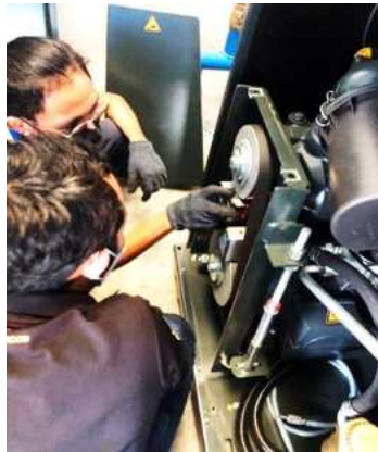
รูปที่ 4.12 การตรวจสอบสภาพสายพานส่งกำลัง
