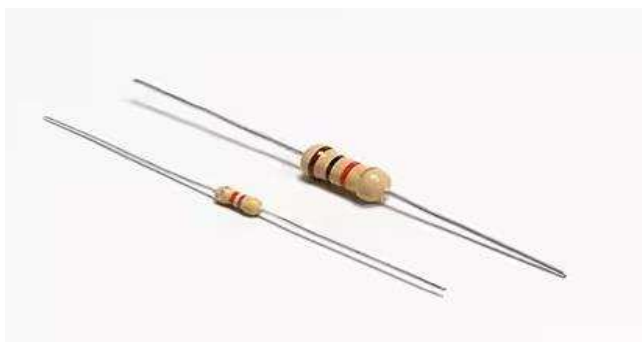
รูปที่ 2.22 ขนาดของตัวต้านทานชนิดค่าคงตัว
