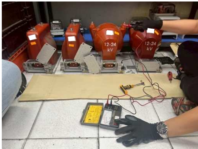
รูปที่ 3.44 การตรวจสอบความปลอดภัยก่อนติดตั้ง
