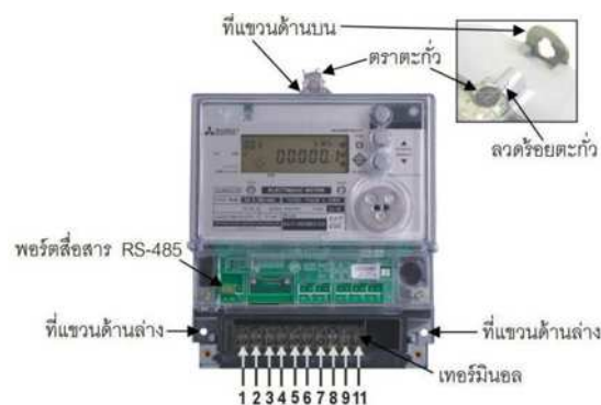
รูปที่ 4.5 มิเตอร์ประเภท 3 เฟส 4 สายประกอบ ซีทีแรงต่ำ
