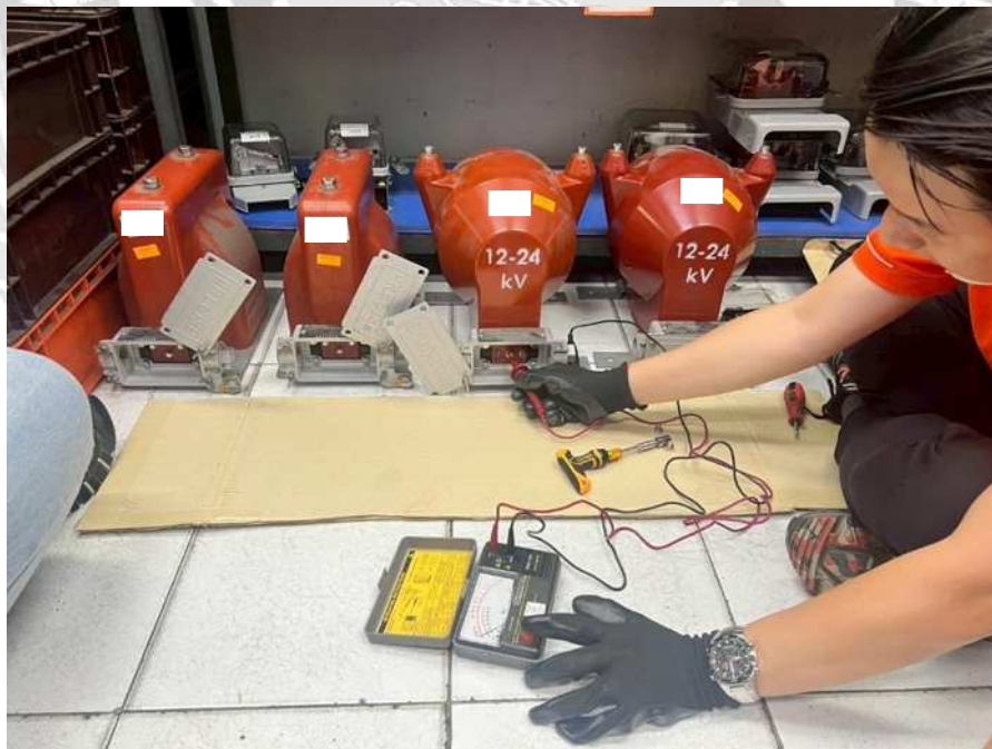
รูปที่ ค 4 การตรวจเช็ค CT VT แรงสูงก่อนนำไปติดตั้ง
