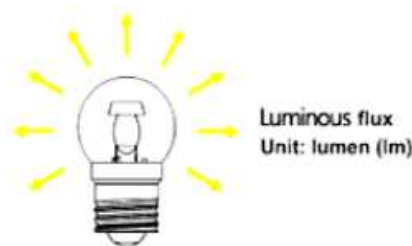
รูปที่ 2.7 ปริมาณแสงที่ออกจากหลอดไฟ
