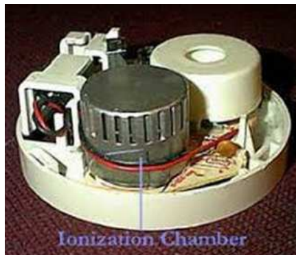
รูปที่ 2.6 อุปกรณ์ตรวจจับควันชนิดไอโอเซชัน (Smoke Detector Ionization Type)
