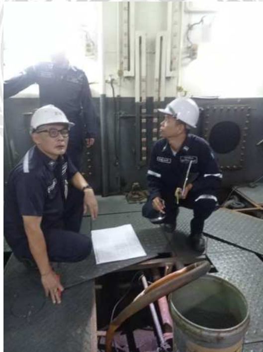
รูปที่ 3.14 ทดสอบการทำงานของสวิทช์ลुकลอย Float Switch
