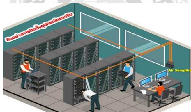
รูปที่ 2.48 การติดตั้งอุปกรณ์ตรวจจับควันชนิดสู่มตัวอย่างอากาศหลายจุด
