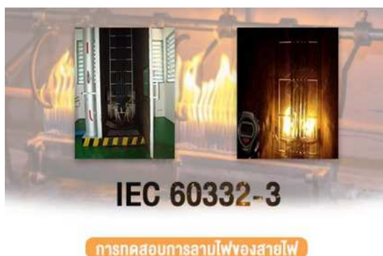
รูปที่ 2.33 การทดสอบการลามไฟของสายไฟ IEC 60332-3
