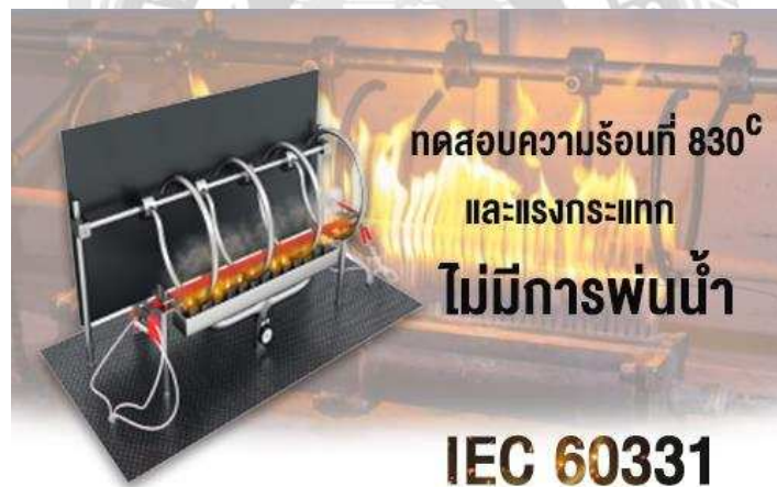
รูปที่ 2.30 การทดสอบสายทนไฟ IEC 60331
