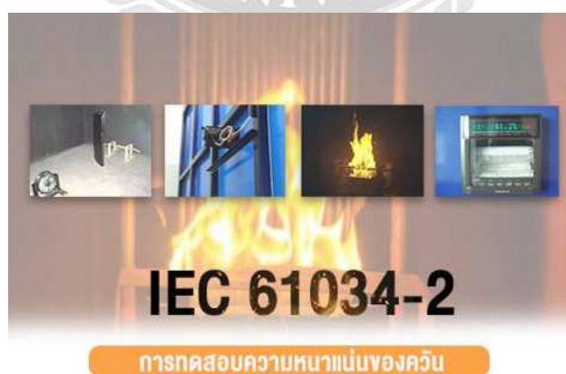
รูปที่ 2.35 การทดสอบความหนาแน่นของควันของสายไฟ IEC 61034-2
