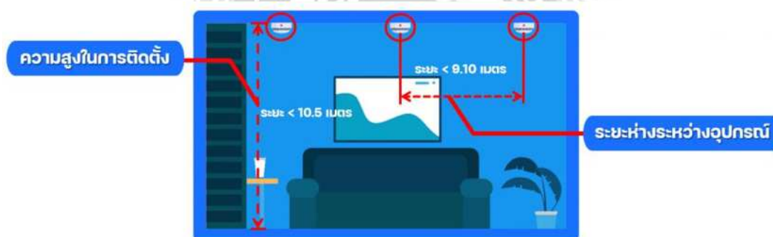
รูปที่ 2.44 ตำแหน่งติดตั้งที่เพดานราบของอุปกรณ์ตรวจจับควัน
