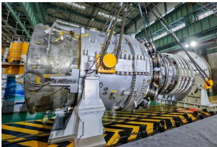
รูปที่ 2.7 เครื่องยนต์ Gas Turbine
