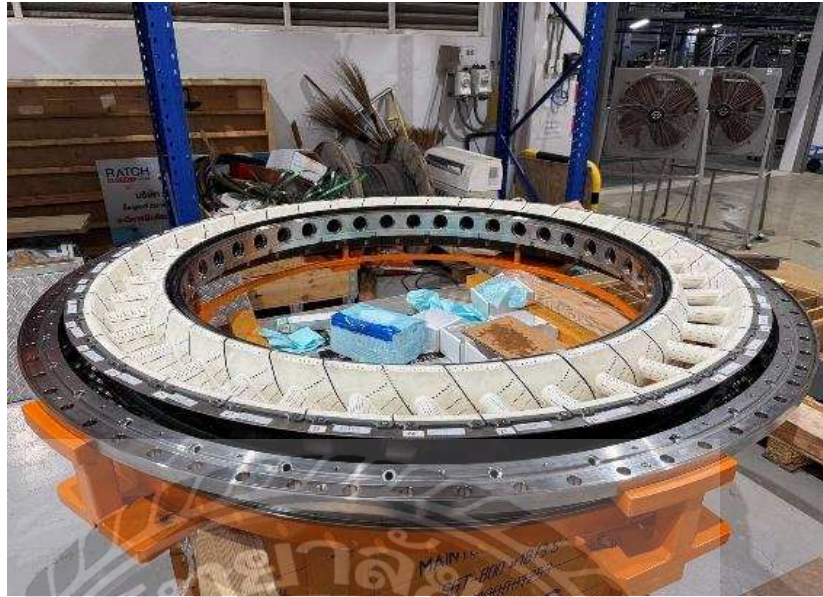
รูปที่ 4.21 Guide Vane ของเครื่องยนต์ Gas Turbine
