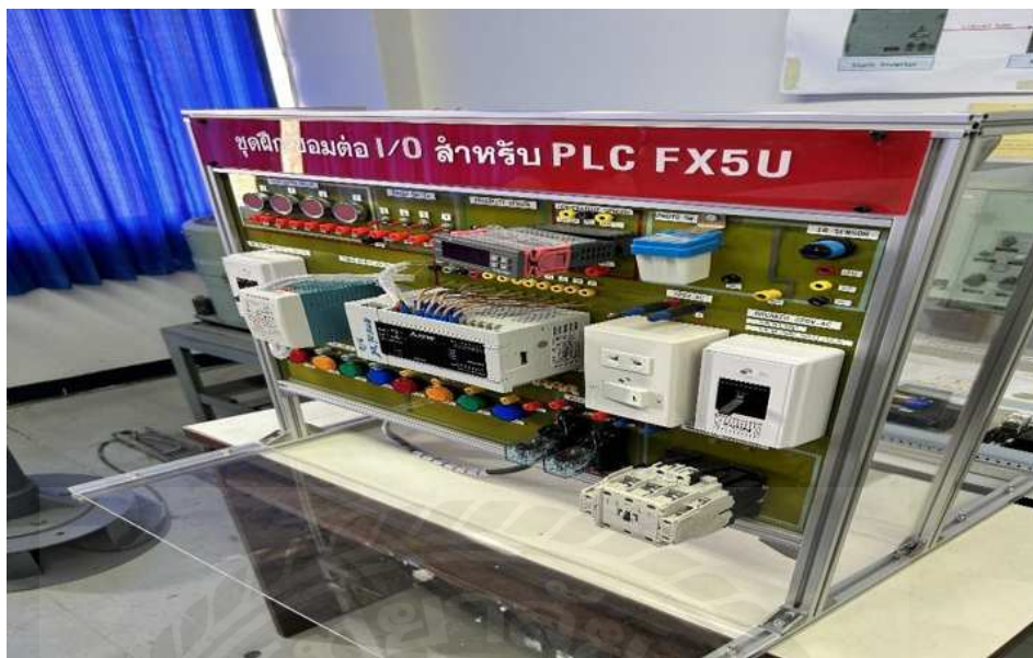
รูปที่ 3.2 การทดสอบเครื่องมือการทดลอง PLC Mitsubishi FX5U
