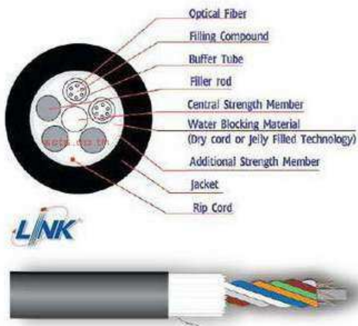
รูปที่ 2.1 ลักษณะทางกายภาพของสายเคเบิลใยแก้วนำแสง
