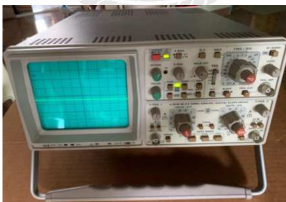
ภาพที่ 2.7 ออสซิลโลสโคปแบบอนาล็อก Hameg HM 305
