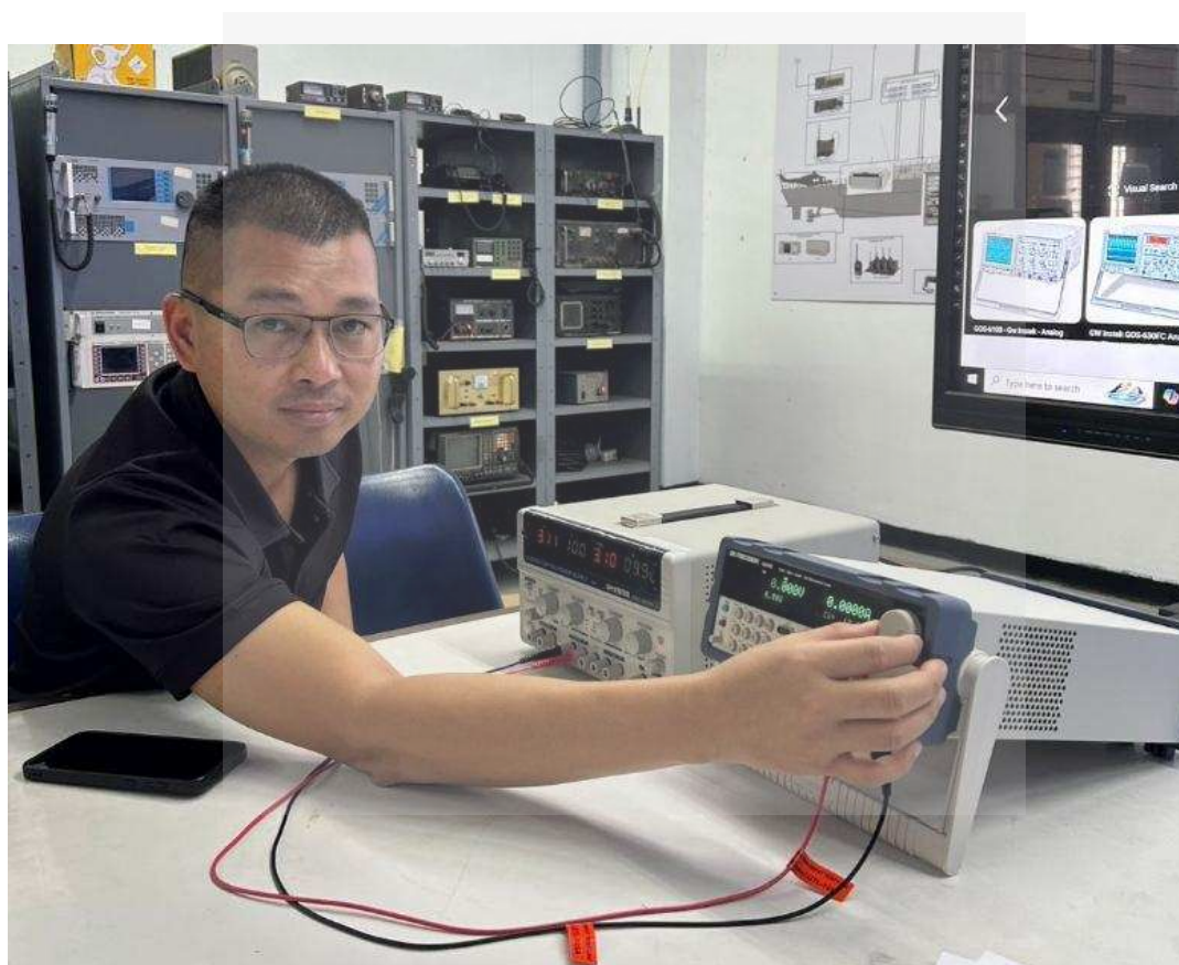
ภาพที่ 3.10 การตรวจสอบสภาพและการทำงานของแหล่งจ่ายไฟ DC และเครื่องกำเนิดสัญญาณก่อนการใช้งาน
