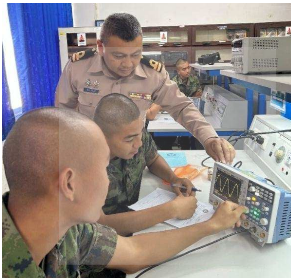
ภาพที่ 3.7 สาธิตการปรับตั้งค่าออสซิลโลสโคปแบบดิจิทัลเพื่อวัดสัญญาณรูปคลื่นไซน์ (Sine Wave)
