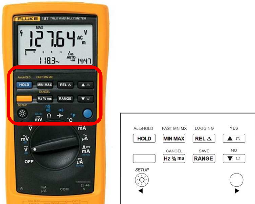
ภาพที่ 2.6 แสดงตำแหน่งและลักษณะการทำงานของปุ่มกดต่าง ๆ
