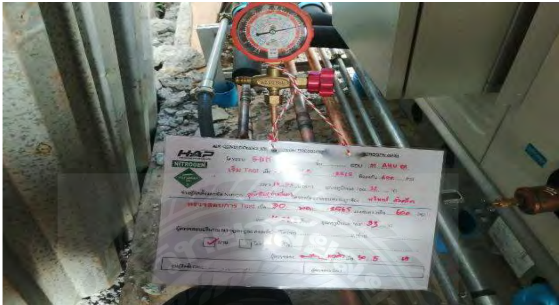
รูปที่ 3.25 การทดสอบรั่วเฉพาะระบบท่อ ที่แรงดัน 600 PSI
