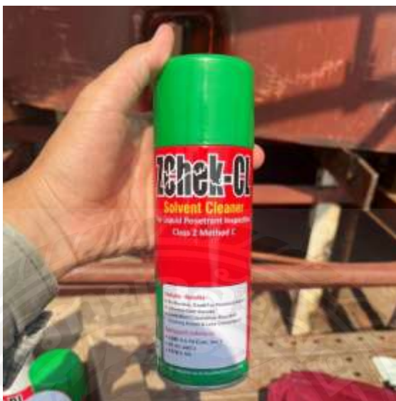
รูปที่ 2.13 ตัวอย่างน้ำยากำจัดสารแทรกซึมที่ใช้ในงานตรวจสอบแนวเชื่อมหุยก Block โครงสร้างเรือ
