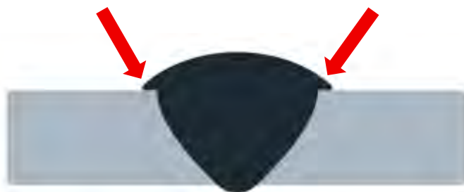
รูปที่ 2.4 แนวเชื่อมที่มีเนื้อโลหะล้นออกมาจากแนว
