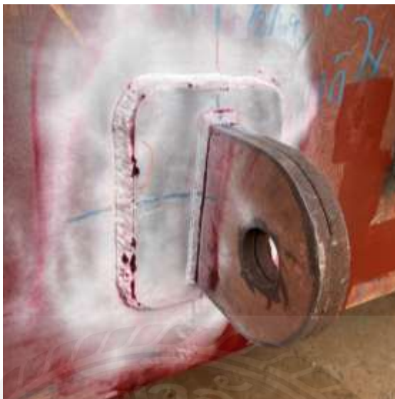
รูปที่ 2.19 ตัวอย่างหลังจากการพ่นดีเวลอปเปอร์ลงบนผิวแนวเชื่อม
