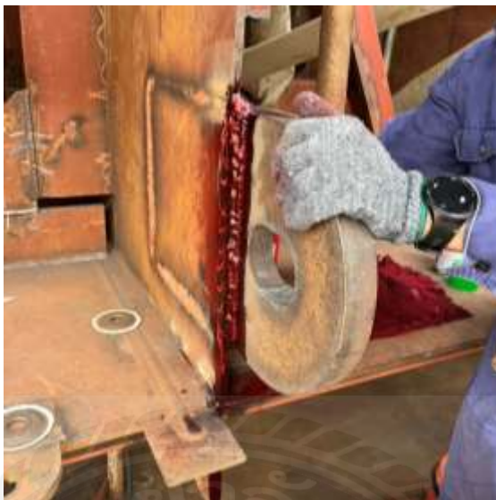
รูปที่ 2.18 ตัวอย่างหลังจากพ่นน้ำยาแทรกซึมลงไปแนวเชื่อม
