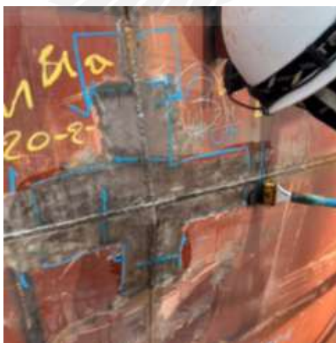
รูปที่ 2.28 ตัวอย่างการเตรียมพื้นผิวก่อนทำการทดสอบ
