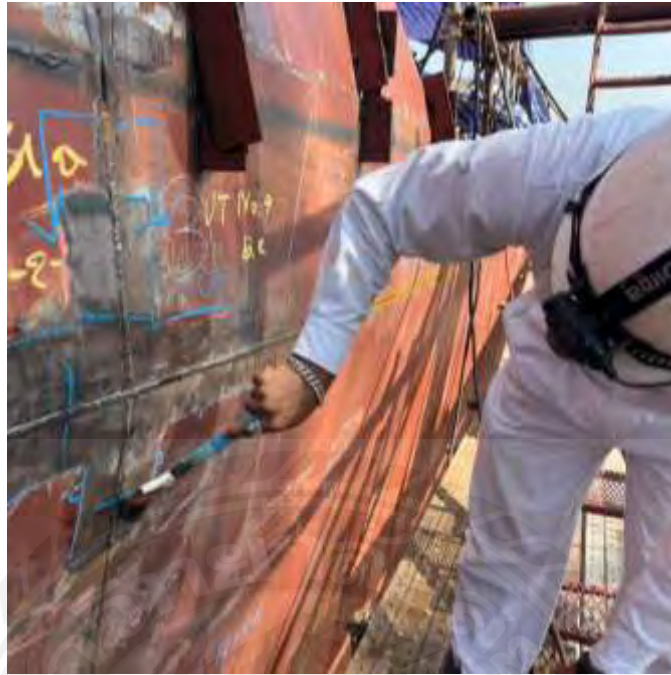
รูปภาคผนวกที่ 4 ขณะทาสารช่วยสัมผัสเพื่อเตรียมทดสอบ UT
