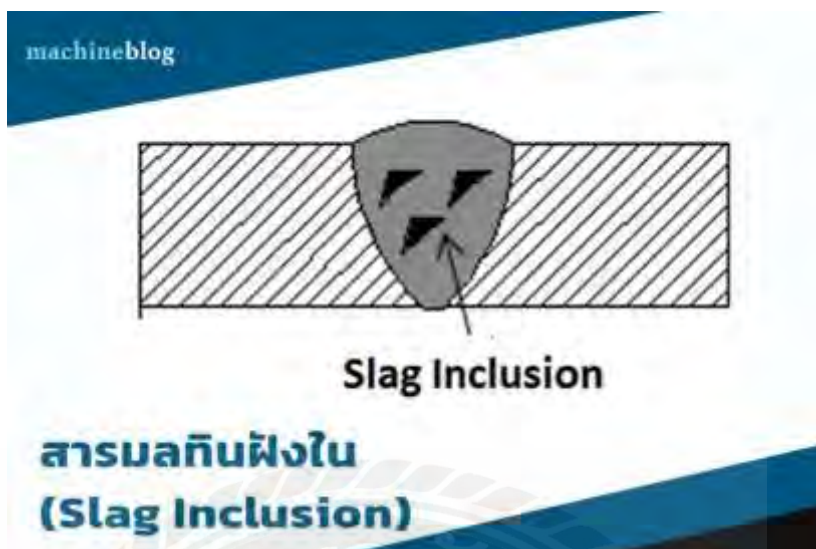
รูปที่ 2.36 ตัวอย่างแนวเชื่อมที่มีแผลกฝังใน
