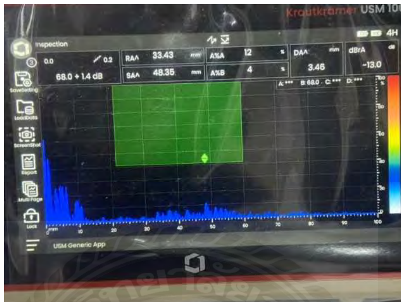
รูปที่ 4.5 ตัวอย่างผลทดสอบวิธี UT ที่มีข้อบกพร่องใด ๆ บนแนวเชื่อม
