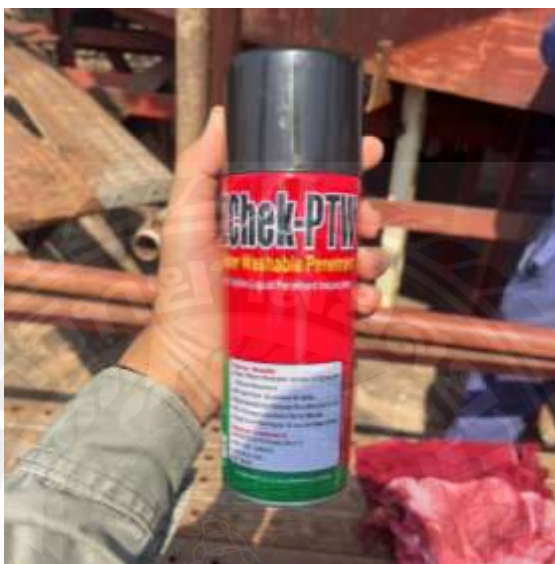
รูปที่ 2.12 ตัวอย่างสารแทรกซึมที่ใช้ในงานตรวจสอบแนวเชื่อมหูก Block โครงสร้างเรือ
