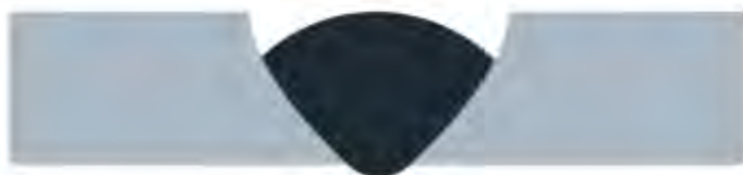
รูปที่ 2.7 แนวเชื่อมที่มีระดับต่ำกว่าผิวชิ้นงาน
