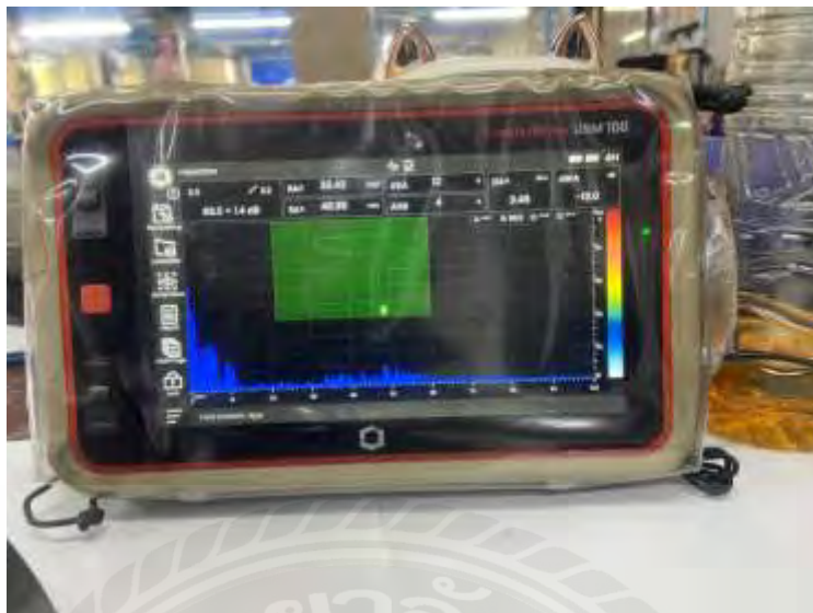
รูปที่ 2.25 ตัวอย่างหน้าจอแสดงผลแบบ A-Scan ที่ใช้ในการทดสอบแนวเชื่อมด้วยวิธี UT
