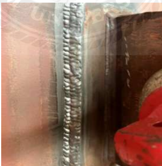
รูปที่ 2.16 ตัวอย่างแนวเชื่อมที่ผ่านการเตรียมพื้นผิวแล้ว
