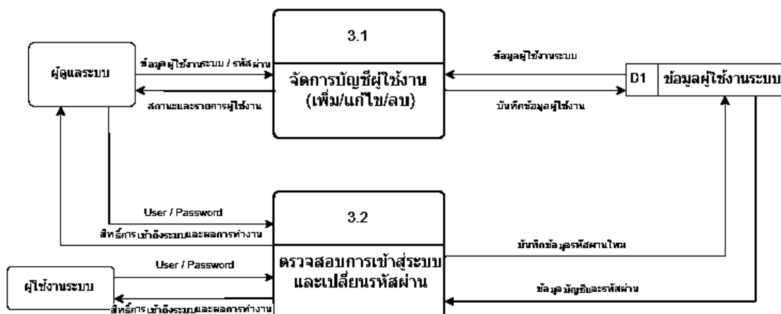
รูปที่ ก.5 Data Flow Diagram Level 1 ของ Process 3: จัดการผู้ใช้งาน
